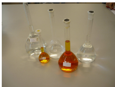
Disoluciones de \text{FeSCN}^{2+} y sensor colorimétrico utilizados en la experiencia
