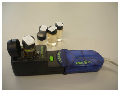
Disoluciones de \text{FeSCN}^{2+} y sensor colorimétrico utilizados en la experiencia
